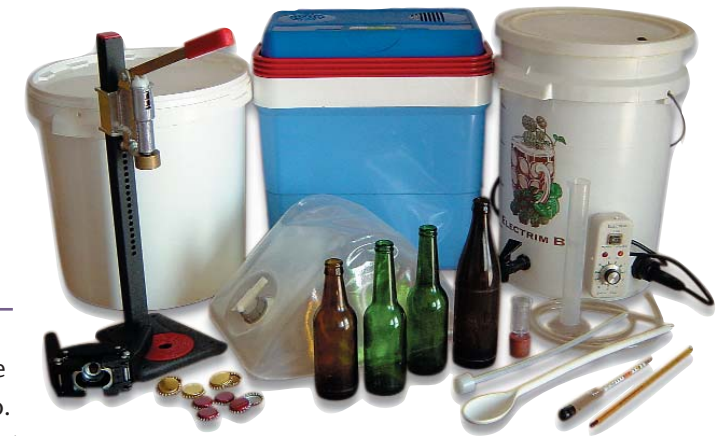
Equipos empleados habitualmente para elaborar cerveza: fermentador, termonevera, caldero, chapadores y chapas, fermentador secundario, botellas, borboteador, probeta, tubos de silicona, tubo U, cuchara, densímetro y termómetro.
